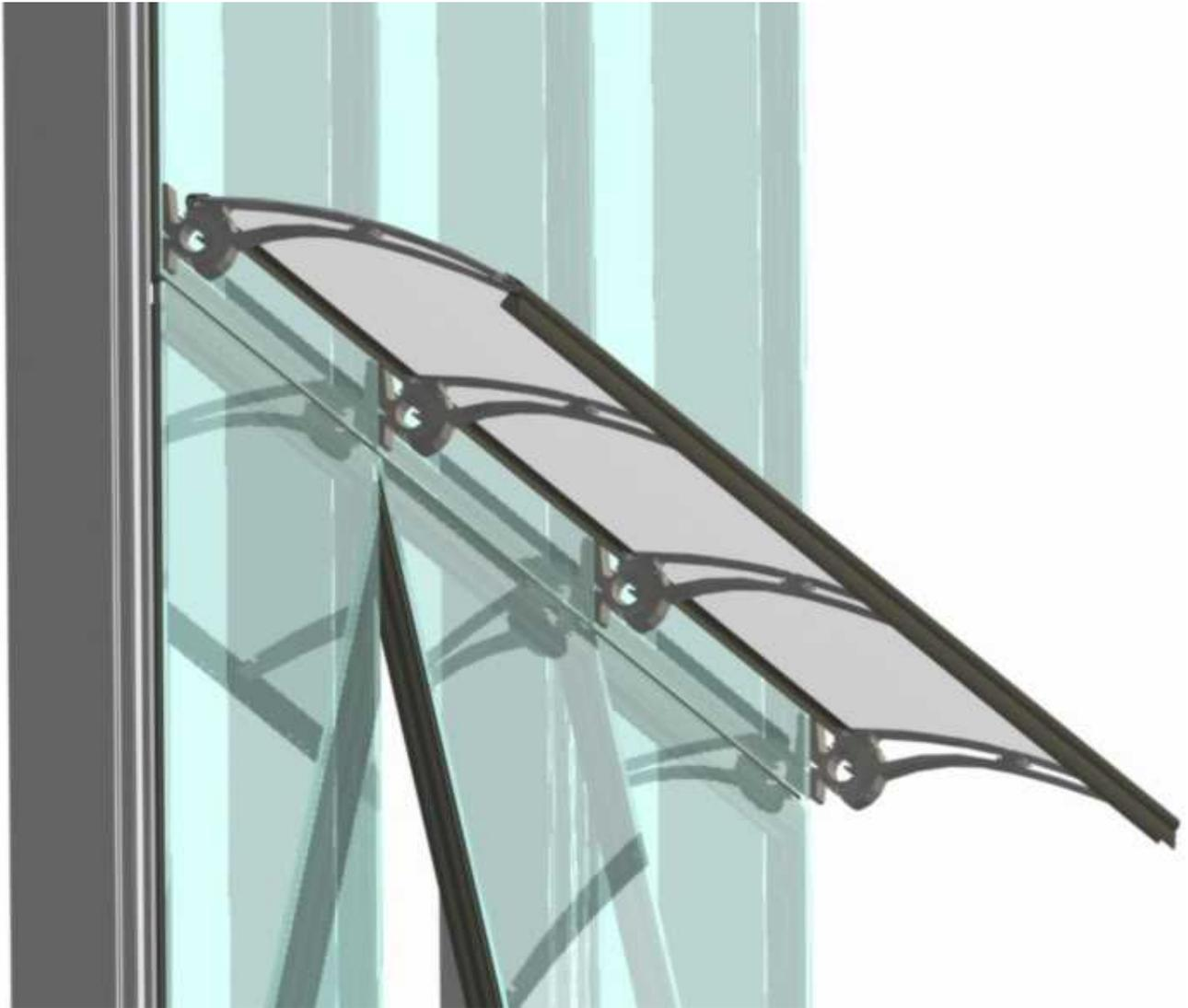
Sistema de Control Solar para aplicar sobre diferentes tipos de fachadas (hormigon, mamposteria, vidriadas o metalicas) recicladas o nuevas. Sistema de anclaje para soporte de angulo variable fijo para lamas de colocacion horizontal de 400 y 200 mm.
