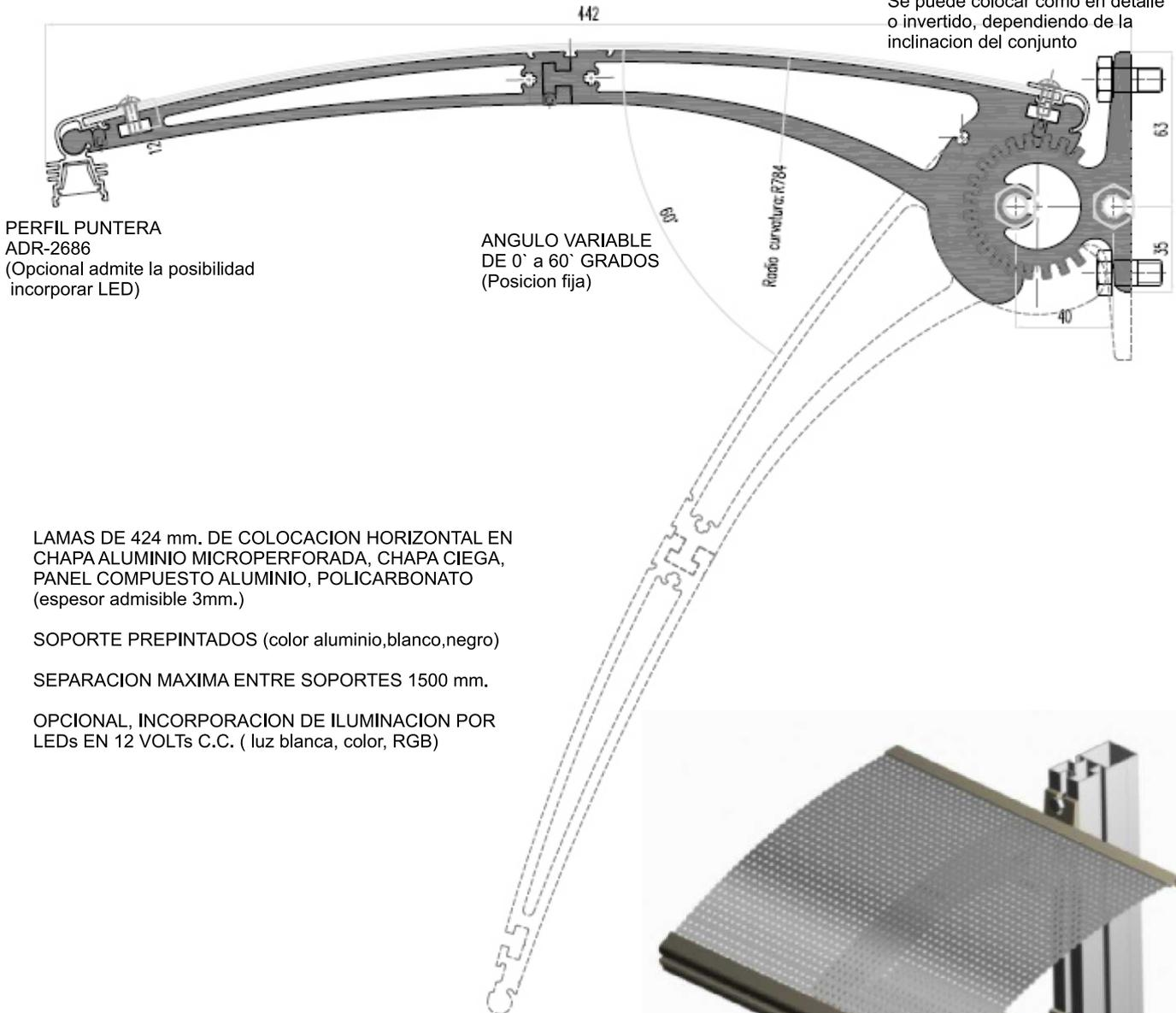
LAMAS DE 424 mm. DE COLOCACION HORIZONTAL EN CHAPA ALUMINIO MICROPERFORADA, CHAPA CIEGA, PANEL COMPUESTO ALUMINIO, POLICARBONATO (espesor admisible 3mm.)
