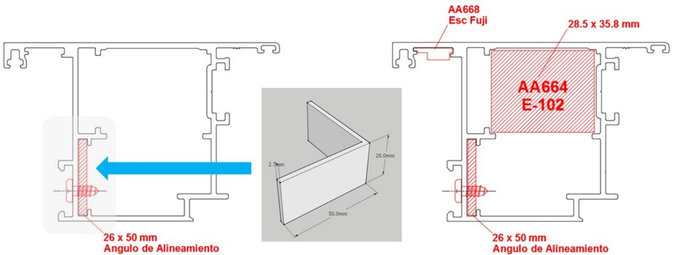
6. Se aumenta el espesor de la pared donde trabajan las bisagras de aplicar de 1.8 mm a 2 mm por especificación de los fabricantes de este tipo de herrajes.
