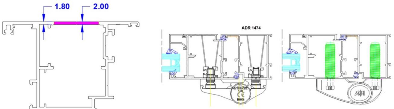
7. Se elimina del diseño actual la curva que obliga a utilizar retestadora para el armado del zócalo y del travesaño de puerta:
