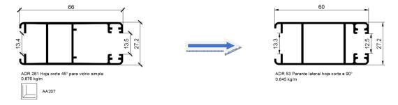
El ADR 261, a diferencia del ADR 53, permite "insertar" el cierre lateral sin necesidad de tener que hacer un mecanizado adicional para el gancho de cierre en la pared frontal del perfil y además puede ser utilizado tanto para armado a 90° como a 45°.
